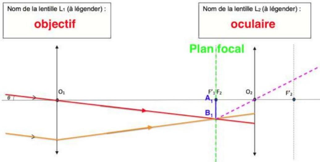
$A_1 B_1$  étant sur le plan focal, il donnera une image à l'infini, tous les rayons issus de  $B_1$ , passant par la lentille  $L_2$  seront parallèles.
