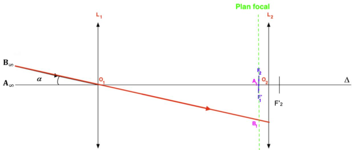
Le faisceau émergent de la lunette issu de  $B_\infty$  et passant par les bords de l'objectif :
