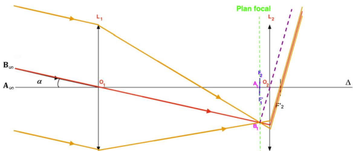
Remarque : L'échelle du schéma ne permet pas de bien voir les rayons au niveau du foyer image. les rayons ne passent pas par  $F'_2$ .
