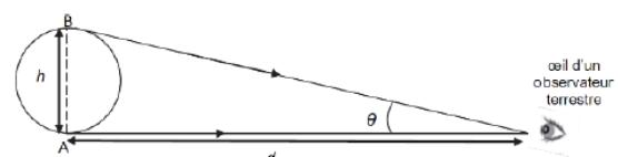
$$\text{Angle sous lequel Mars est vue à l'œil nu : } \theta_M = \frac{h}{D} = \frac{6794 \text{ km}}{62,07 \times 10^6 \text{ km}} = 1,095 \times 10^{-4} \text{ rad.}$$
