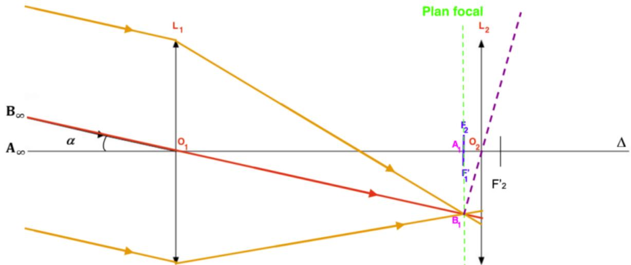
$A_1B_1$  étant sur le plan focal, il donnera une image à l'infini, tous les rayons issus de  $B_1$ , passant par la lentille  $L_2$  seront parallèles.
